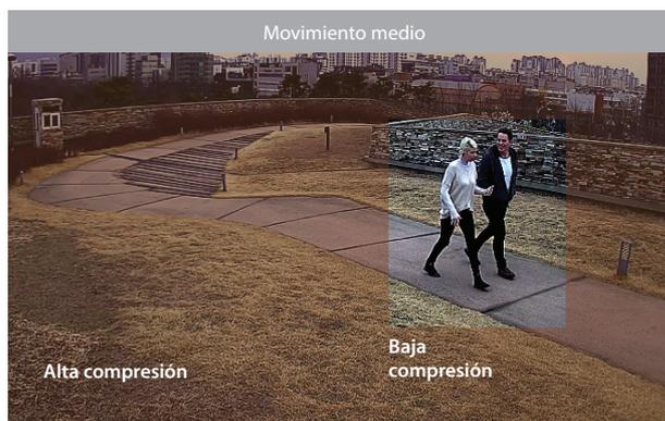
WiseStream II APAGADO : 7434kbps **WiseStream II ENCENDIDO : 3822kbps**
